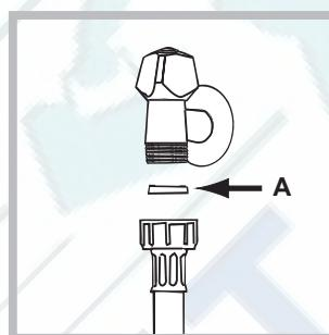
1. Вставьте прокладку А в конец водопроводного шланга и привинтите его к водопроводному крану холодной воды с резьбовым отверстием 3/4 дюйма (см. схему). Перед подсоединением откройте водопроводный кран до тех пор, пока из него не потечет чистая вода.
